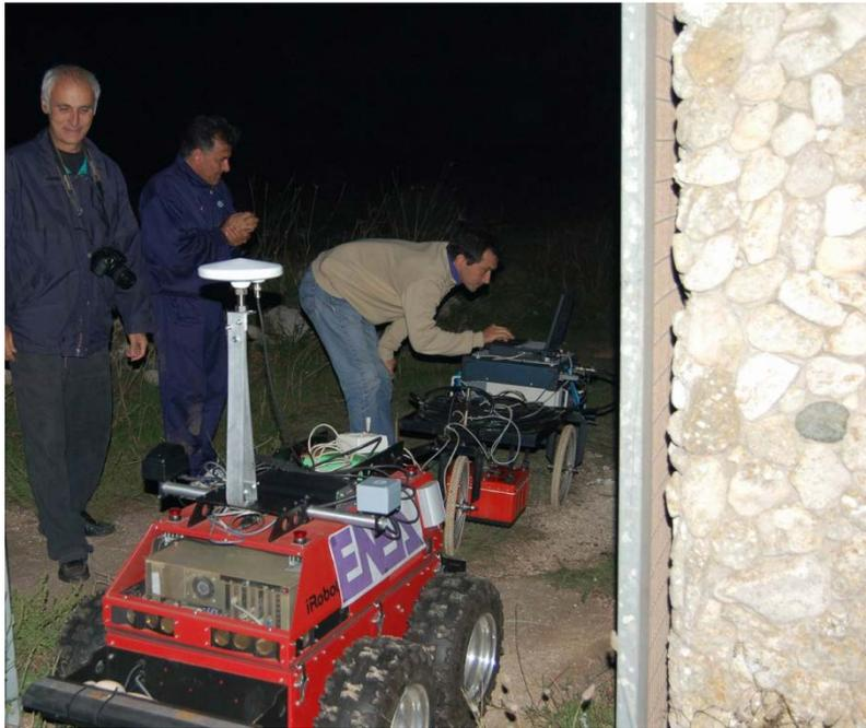
L'inserimento di target ad alta riflettività nella grotta, insieme con l'uso di un potente georadar e di algoritmi per la ricerca e di filtri di Kalman per aumentare la precisione di localizzazione del robot ha consentito di individuare la mappatura della grotta. (progetto PON TECSIS).
