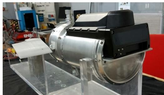
Sistema MultiBeam, installabile sia su AUV VENUS che su ROV in grado di ricostruire una Scena sottomarina con dettaglio 256x256
