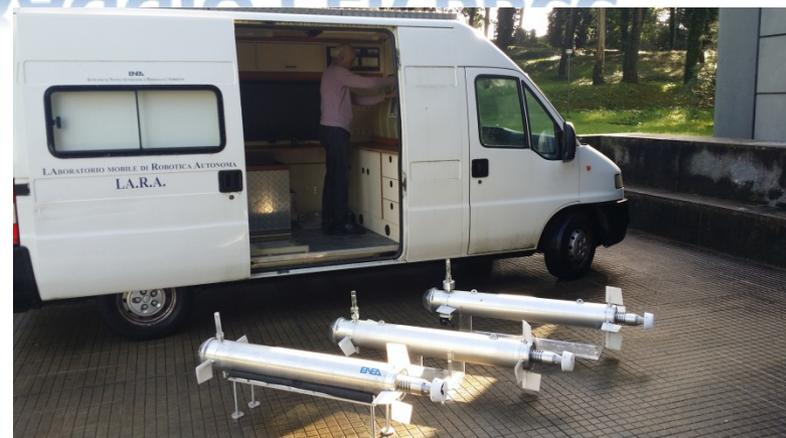
I sistemi robotici autonomi costituiscono uno strumento potente per la ricerca e la localizzazione di reperti archeologici sottomarini. I sistemi VENUS disegnati dall'ENEA e tutt'ora in fase di sviluppo, lavorano con il concetto di swarm, offrendo maggiore robustezza e velocità di esplorazione rispetto ad un singolo robot sofisticato
