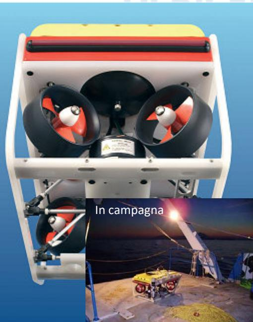
Il Falcon, ROV commerciale in dotazione al laboratorio, consente attività di supporto alle altre risorse del laboratorio oltre che monitoraggi ed esplorazioni indipendenti. E' dotato di braccio di manipolazione, sonar, telecamere e può montare il side scan sonar del laboratorio e il multibeam per operazione in acque torbide.
