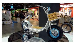
Scooter elettrico, elegante, dal design minimale, pratico e leggero. Veicolo pensato per muoversi liberamente senza inquinare. Scooter elettrico a impatto zero. Realizzato in tubolare di alluminio. Propulsione elettrica, con motore trifase a 48 volt.
