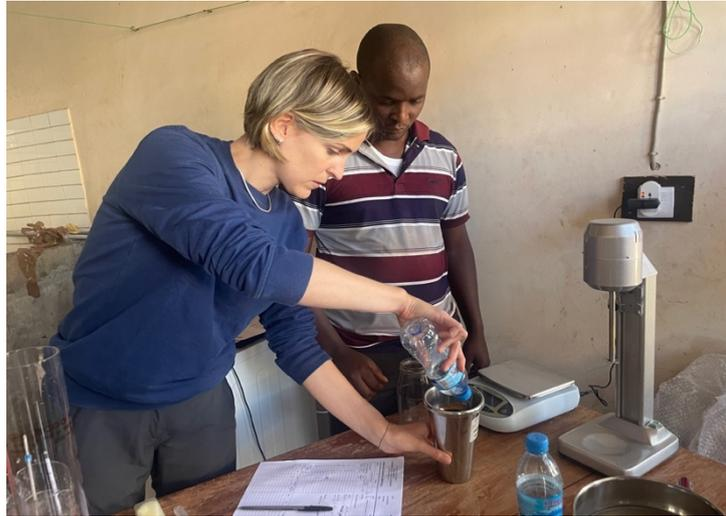
L'analisi granulometrica via setacci e sedimentazione consiste nel determinare la composizione di un terreno in termini di contenuto percentuale di argilla, limo, sabbia e ghiaia.
